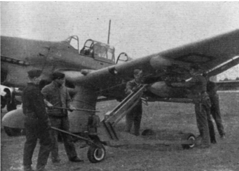
**Abb. 20 Hochpumpen der Bombe mit LCW 500.**
