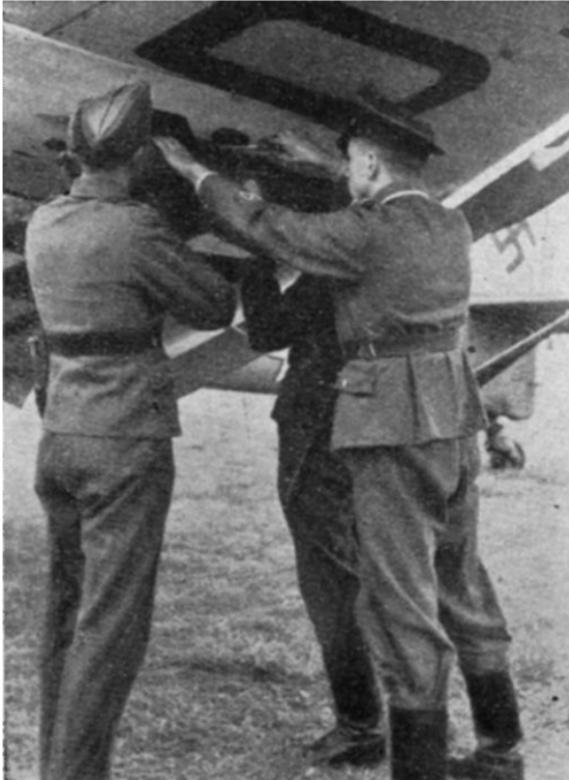
**Abb. 24** Das ETC 50 links außen wird bei Beladung mit einer 50 kg-Bombe geschlossen.
